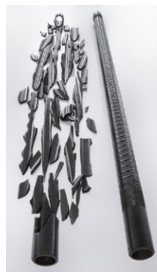
↑ 配备（右）和未配备（左）CARBOGUARD碳化硅管的碎裂状态
